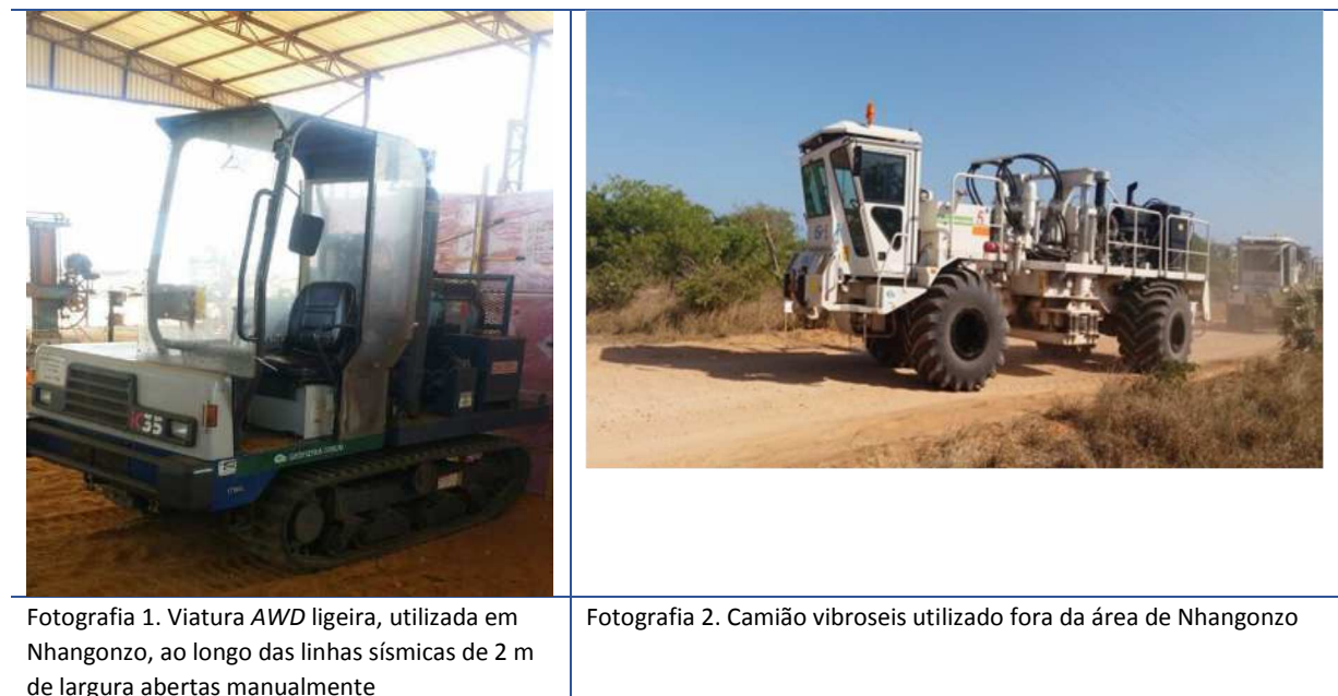
Figura 5-2. Comparação de uma viatura AWD ligeira com um típico camião vibroseis
